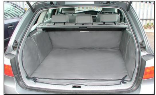
Bild zeigt Standard Kofferraumauskleidung vorbereitet für den Stoßstangenschutz
